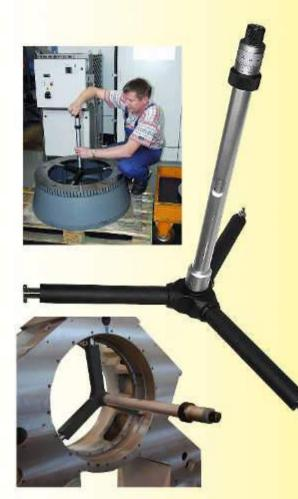
Unser MICROTEST® System ist das Einzige, welches in der Lage ist, Bohrungen von Ø 400mm bis Ø 1150mm exakt zu messen.
