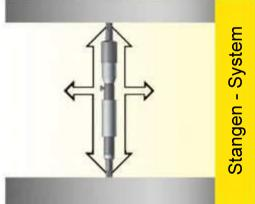
Stangen-Systeme sind besonders schwierig in der Handhabung, da die eingebaute Messspindel von Hand bewegt werden muss, bei gleichzeitiger, manueller von 2 Achsen. Der Zentrierprozess erfordert Fachkenntnisse, Geduld und viel Gefühl. Der Zeitaufwand ist hoch, dabei wird viel Handwärme an das Gerät übertragen, was zu Messfehlern führt. Je grösser der Durchmesser umso schwieriger die Zentrierung.
