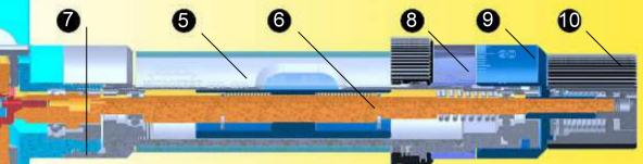
Die Zentralwelle (6) ist mit den Messtastern (1) über ein Kegelrad-Getriebe (4) synchronisiert. Diese Kegelräder übertragen die Rotation, welche mit der Ratsche (10) bzw. der Skalentrommel (9) erzeugt wird, an die Messspindeln (3), um die speziell gut geführten Messtaster (1) in die Messposition zu fahren.
