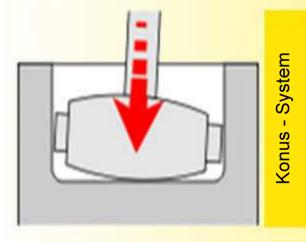
Die Rutschkupplung ermöglicht zwar einen konstanten Messdruck, ist jedoch keine Unterstützung für die Zentrierung; Sie fördert das Verkanten in der Bohrung. Die Streuung beträgt ca. ± 3 - 5 µm. Die Ratsche ermöglicht eine bessere Zentrierung, jedoch ist sie teilweise problematisch, da mehrmaliges Nachratschen den Konus zu weit in das Taster-System drängt und somit das Resultat verfälscht und ebenso Streuungen verursacht.
