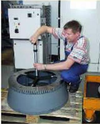
Unser MICROTEST® System ist das Einzige, welches in der Lage ist, Bohrungen von  $\varnothing$  400mm bis  $\varnothing$  1150mm exakt zu messen.
