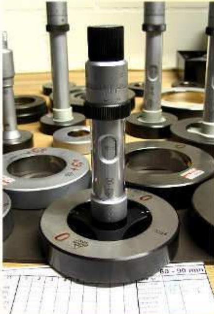
Das Genauigkeitszertifikat das seit der Firmengründung mit jedem Gerät ausgeliefert wird, zeigt dem Anwender die Linearitätsgenauigkeit an verschiedenen Punkten über den ganzen Messweg auf.
