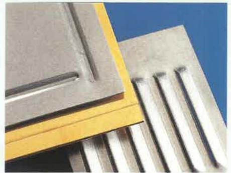
**Herstellung von Lüftungsschlitzen und Verstärkungsrippen mit Profiform 200 und 320**
