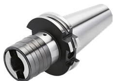
Gewindeschneid-Schnellwechsel-futter mit Längenausgleich auf Druck und Zug
